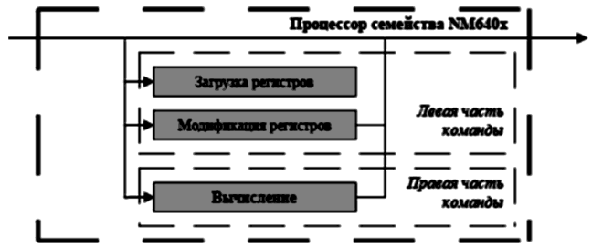
Рис. 3. Выполнение скалярной команды процессора, представленное в виде параллельной системы
